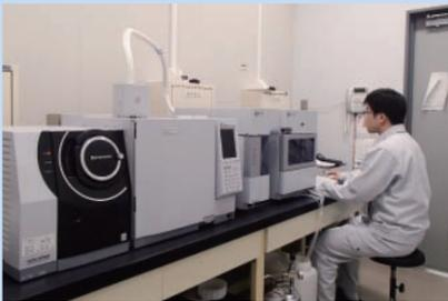
ガスクロマトグラフ質量分析計による揮発性有機化合物(VOC)等の検査を行います。
