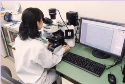
光学顕微鏡等による藻類・微生物・原虫類(クリプトスポリジウム等)の検査を行います。
