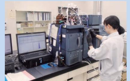
高速液体クロマトグラフ質量分析計によるハロ酢酸類、農薬、ガスクロマトグラフ質量分析計による臭気原因物質、消毒副生成物、農薬等の検査を行います。
